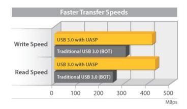
Les tests ont été exécutés sur un système Intel® Ivy Bridge équipé de cartes USB 3.0 StarTech.com, d'un boîtier StarTech.com compatible UASP et d'un SSD SATA III.
